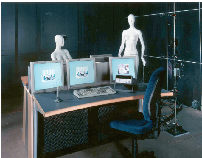
Figuur 5. Rechte handelaarstafel met werkelijke warmtebronnen en LTG ventilatorconvector, type VKT, in ontwikkelingslab van LTG.
