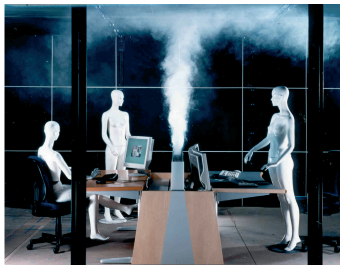
Figuur 6. Ruimtestromingsmetingen aan een rechte handelaarstafel met werkelijke warmtebronnen en LTG ventilatorconvector, type VKT, bij maximale last in ontwikkelingslab van LTG.
